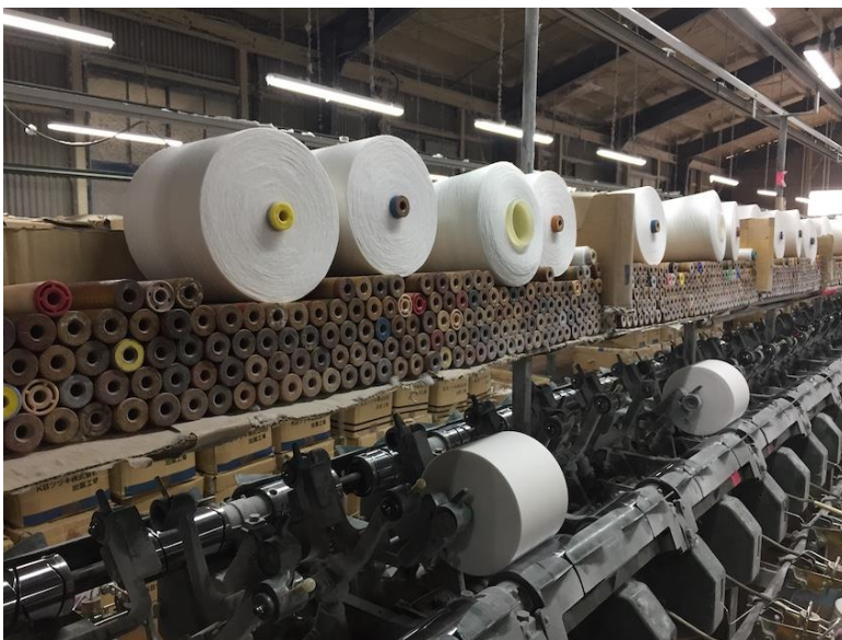
再びボビンから木管に綿糸を巻き替えている様子
