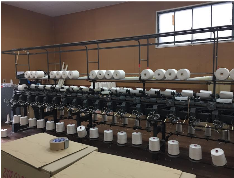
下段の木管または紙管（紡績糸） から上段のポビンに巻き返している様子
