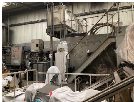
不純物をなるべく時間をかけて浮遊されるため工場の天井は高い（左）
