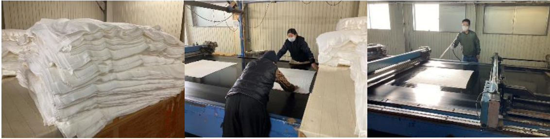
糊抜きされたタオル地 二人がかりでタオルを伸ばす 表面の凸凹を平面にする
