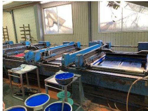
捺染機に調合した染料をスケージゴム （スキージゴム）で擦り落とし固着させる
